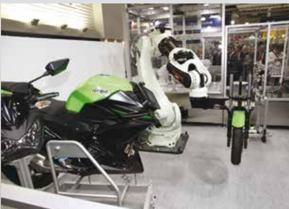
Ukázka manipulace s BX robotem, montáž přední vidlice motocyklu
