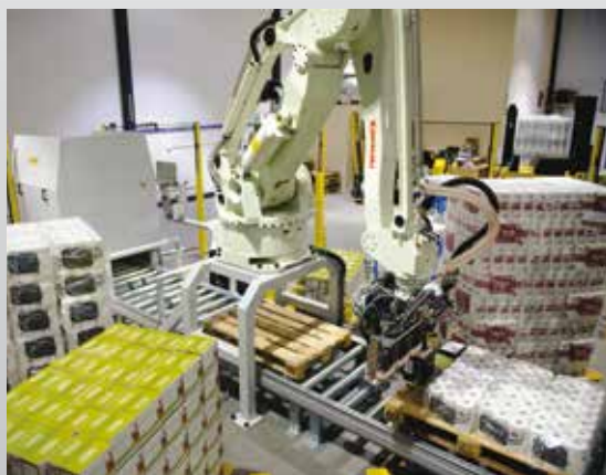
Paletizace různých výrobků v jedné buňce
