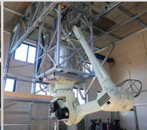
Speciální aplikace – montáž robota na strop
