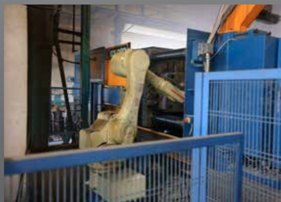
Zakládání polotovárů/ vykládání hotových obrobků - CNC stroje a vykládání vylisků ze vstříkolisů
