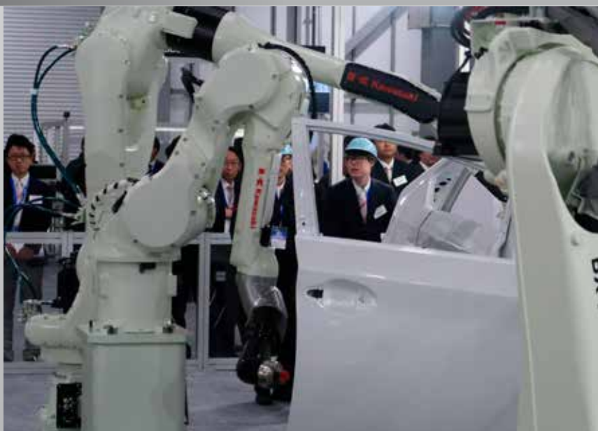
Ukázka nových robotů BXP110L – svařování; KJ155 – lakování vnitřních částí dveří; BU015X – nanášení tmelu uvnitř karosérie
