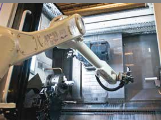
Zakládání polotovárů/ vykládání hotových obrobků - CNC stroje a vykládání vylisků ze vstříkolisů
