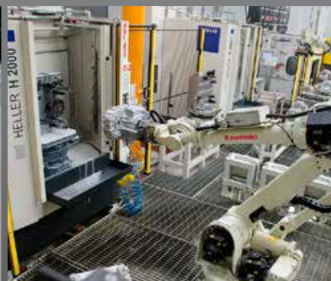
Zakládání polotovárů/ vykládání hotových obrobků - CNC stroje a vykládání výlisků ze vstříkolisů
