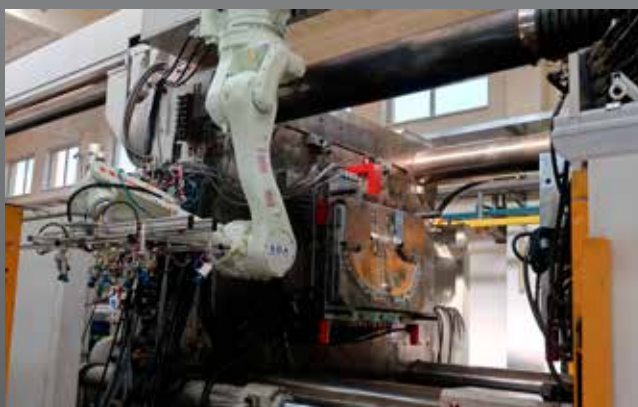
Zakládání polotovárů/ vykládání hotových obrobků - CNC stroje a vykládání výlisků ze vstříkolisů
