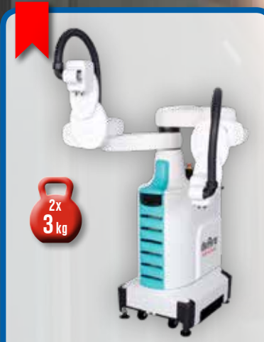
Kolaborativní 2-ramenný SCARA robot DuAro | s.34
