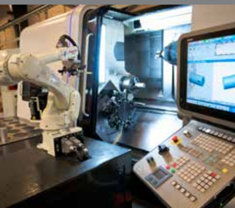
Zakládání polotovárů/ vykládání hotových obrobků - CNC stroje a vykládání výlisků ze vstříkolisů
