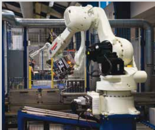
Technologická operace kování oken s následnou manipulací
