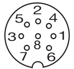
Obr. 4-2: Rozmístění pinů BKS konektorů BTL
